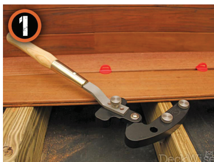
Positionnez l'outil Hardwood Wrench™ sur la sous-construction. Setzen sie die Hardwood Wrench™ auf die Unterkonstruktion an.
