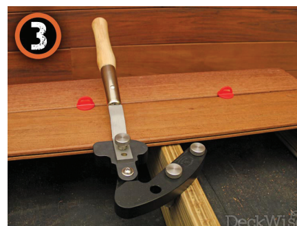
Came de verrouillage en place, celle-ci maintient la lame en place pendant que les fixations sont installées. Der Exzenter rastet ein und hält die Dielen in Position, während die Befestiger montiert werden
