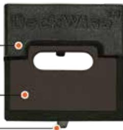
Les clips de fixation de DeckWise® ne sont pas comme les autres fixations en acier, qui peuvent réagir avec les huiles naturelles du bois et qui peuvent provoquer des taches. Le clip Extreme® est constitué d'une coque en plastique durcie d'une résine polymère avec une résistance aux UV et aux produits chimiques et renforcé avec un insert en acier inoxydable.
